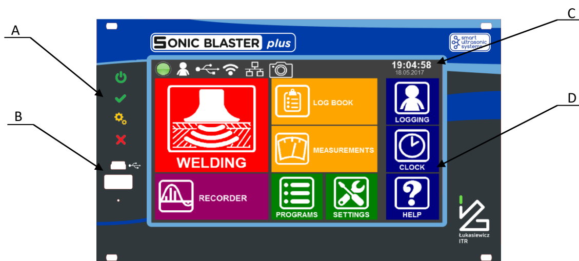
Rys. 14 Widok płyty czołowej wraz z opisem głównych elementów
