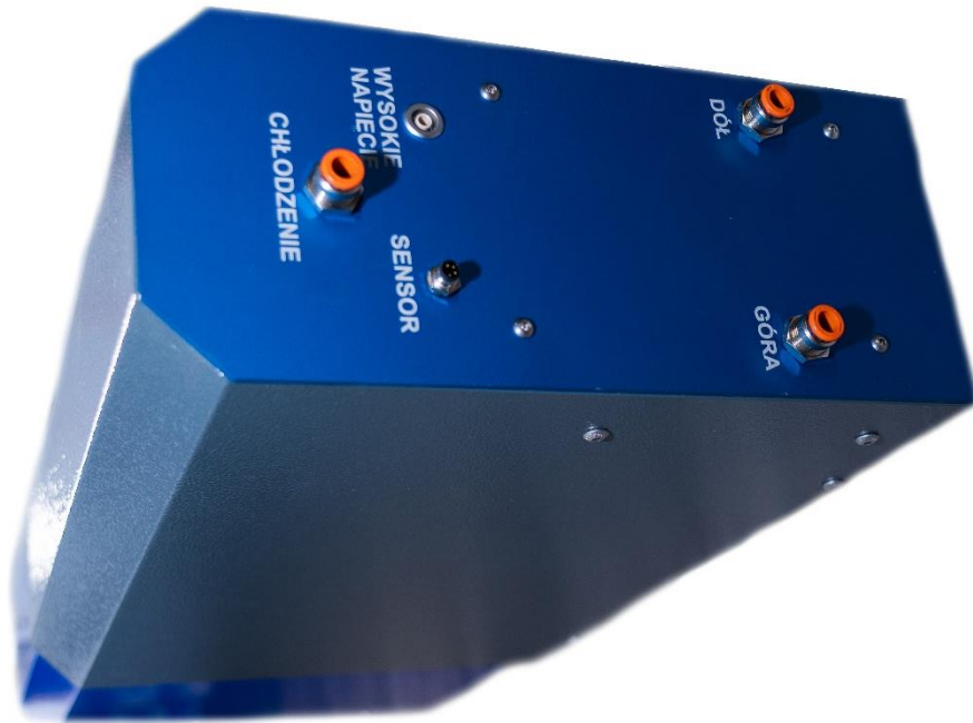
Rys. 5. Moduł zgrzewania ultradźwiękowego Sonic Actuator – widok panelu przyłączeniowego
